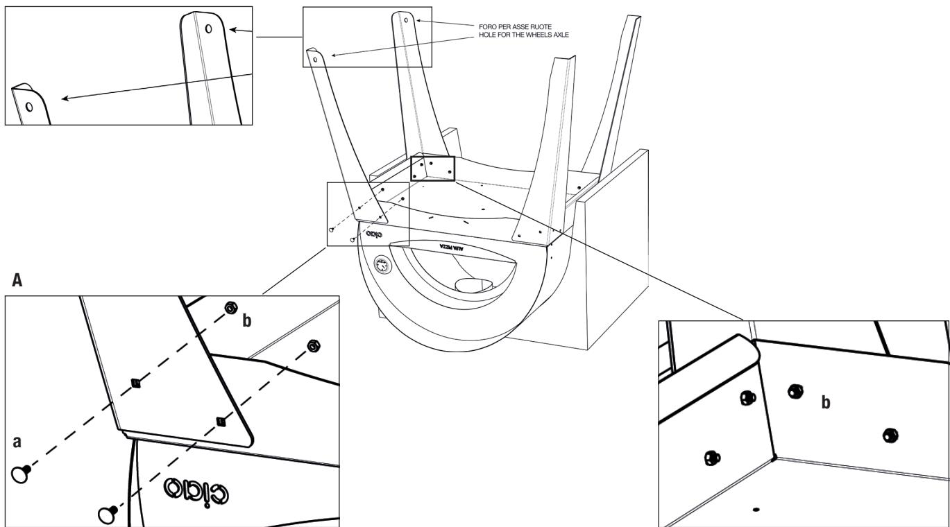
**FR** Visser les boulons (a) et les dés (b) des pieds comme cela est décrit sur l'image (a) en faisant attention au positionnement des pieds (regarder la photo, les deux pieds avec le trou pour les roues vont du côté du thermomètre).
