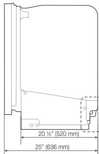
El conducto, el cable de alimentación y la manguera de desagüe deberían pasar por el espacio detrás del lavavajillas. Luego, los mismos pasan a través de canales debajo del lavavajillas hacia las conexiones de la parte delantera.
