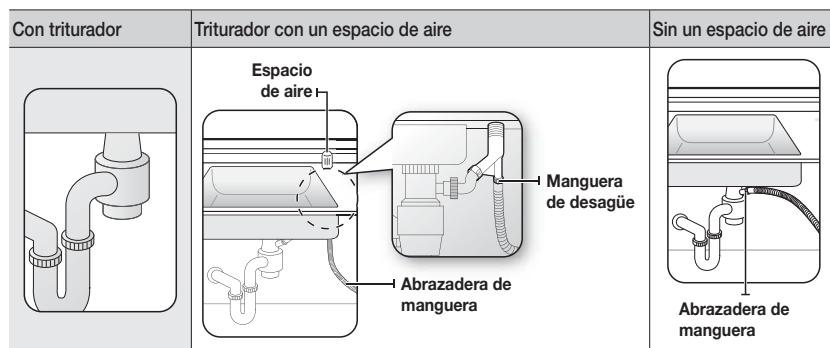
3. Verifique el tamaño del conector de la manguera de desagüe del fregadero. Si es necesario, corte la manguera de desagüe para que encaje en el conector del fregadero ( $\frac{1}{2}$  pulgada,  $\frac{3}{4}$  de pulgada o 1 pulgada, como se muestra en la Figura 11 siguiente). Si el extremo de la manguera de desagüe no calza en el conector de la manguera de desagüe del fregadero, use un adaptador que pueda adquirir en un negocio de suministros de plomería/ ferretería.
