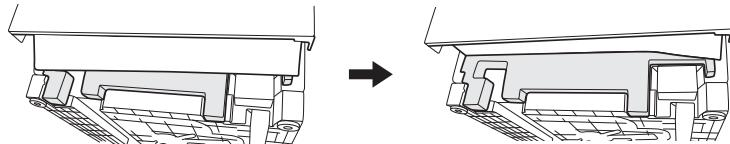
6. Verifique que el burlete de la placa de protección esté en la parte inferior de la placa de protección. Para la instalación de la placa de protección, consulte la siguiente figura.
