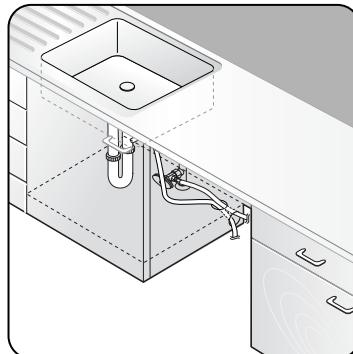
El orificio para el conducto, la manguera de desagüe y los cables de alimentación.
