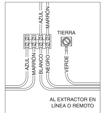
Cableado del extractor en línea/remoto.
