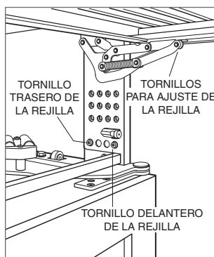
Ajuste de la altura de la rejilla.
