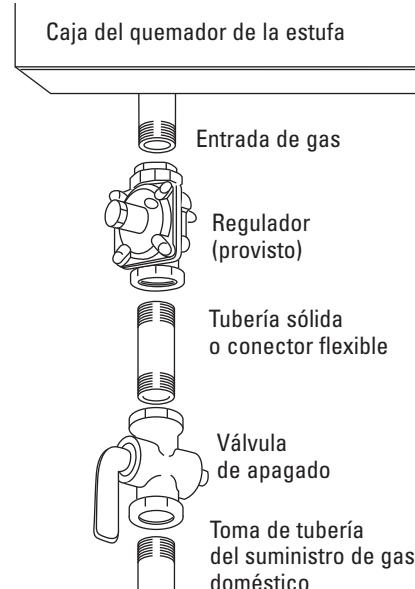
**IMPORTANTE:** Desconecte la estufa y la válvula individual de apagado del sistema de tubería de suministro de gas durante cualquier prueba de presión del sistema a presiones de prueba mayores a 1/2 psig. Aíslle la estufa del sistema de tubería de suministro de gas cerrando la válvula individual de apagado hacia la estufa durante cualquier prueba de presión del sistema de suministro de gas en presiones de prueba iguales o menores a 1/2 psig.
