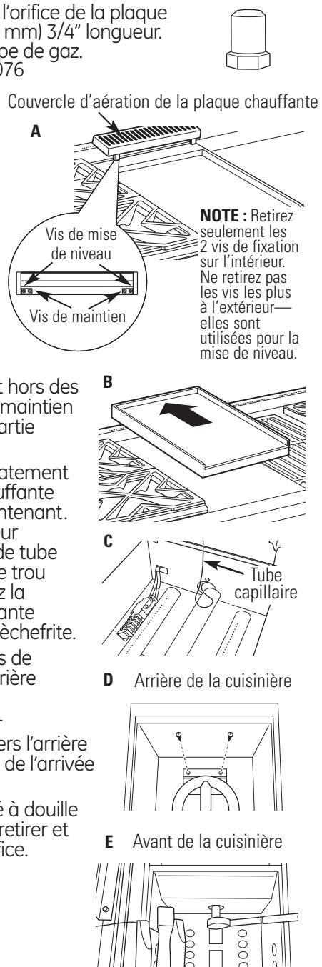
Inversez la procédure pour remonter la plaque chauffante. Repoussez la longueur excédentaire de tube capillaire dans le trou d'entrée. Placez l'orifice non utilisé sur le possible pour une possible utilisation ultérieure.
