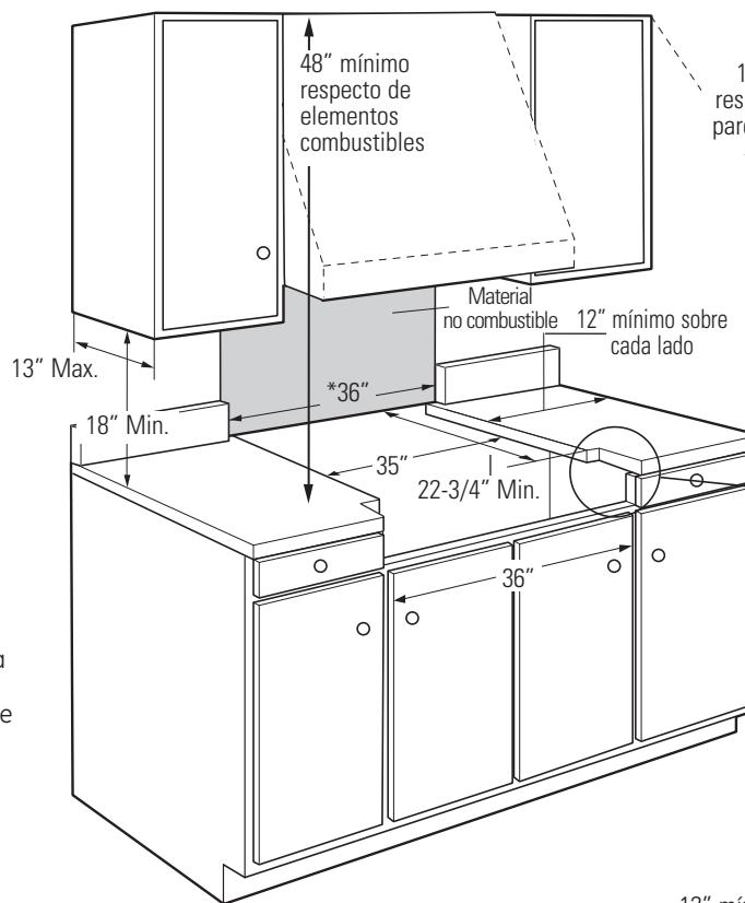
\* La abertura entre un salpicadero de 4" de altura debe ser de 36" para permitir que la estufa se deslice de vuelta contra la pared.
