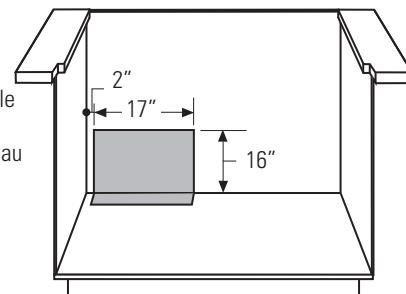
Placez l'arrivée de gaz sur le panneau arrière ou sur la base, à 2" (5 cm) du panneau arrière.
