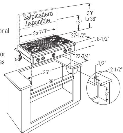
Los modelos de 36" de ancho se encuentran diseñados para usarse en gabinetes con una base de 36" o más.
