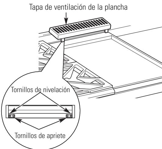
Los dos tornillos internos son tornillos de apriete para asegurar la plancha en su lugar. Afloje los dos tornillos antes de nivelar. No quite estos dos tornillos.
