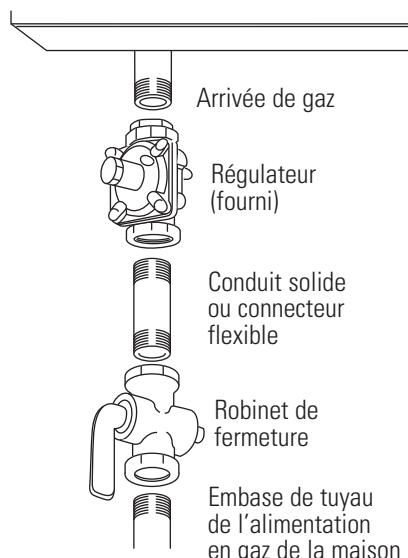
**IMPORTANT:** débranchez la table de cuisson et le robinet de fermeture du conduit d'alimentation de gaz pendant le test de pression du système à des pressions de test supérieures à 1/2 psig. Isolez la table de cuisson du conduit d'alimentation de gaz en fermant le robinet à fermeture manuelle au niveau de la table de cuisson pendant le test de pression du système à des pressions de test égales ou inférieures à 1/2 psig.
