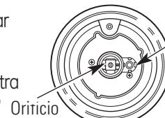
El orificio principal se encuentra en la parte inferior del centro del quemador, mientras que el orificio de fuego lento se encuentra más arriba al lado del centro del quemador.
