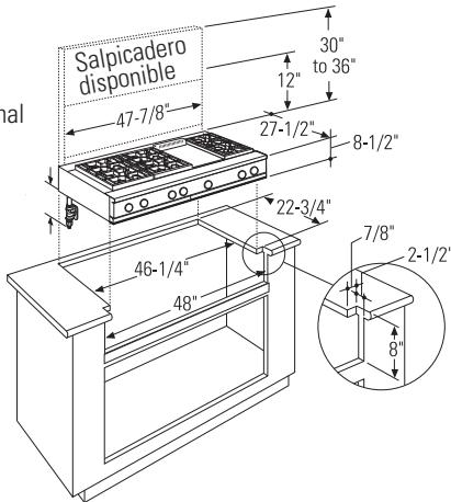
Los modelos de 48" de ancho se encuentran diseñados para usarse en gabinetes con una base de 48" o más.
