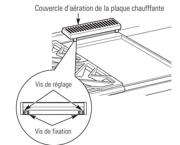
Les deux vis intérieures sont des vis de fixation qui maintiennent la plaque en place. Desserrez les deux vis avant de régler. Ne retirez pas ces deux vis.
