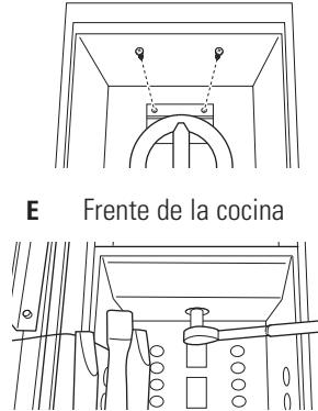
Realice los pasos hacia atrás para volver a ensamblar la plancha. Vuelva a colocar el capilar excesivo nuevamente en el orificio de entrada. Coloque el orificio no utilizado en el soporte para posibles usos futuros.
