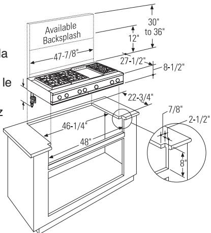
Les modèles d'une largeur de 1,2 m (48") ont été conçus pour les encastrer dans des placards 1,2 m (48") ou plus
