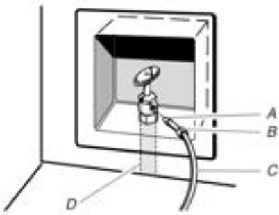
A. Ampoule B. Écrou C. Tuyau en cuivre ou en polyéthylène réticulé (vers le réfrigérateur) D. Conduite d'alimentation du domicile (1/2 po minimum)
