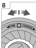
8 Déplacez la meule supérieure réglable, 1 chiffre, mouture plus grossière ou plus fine
