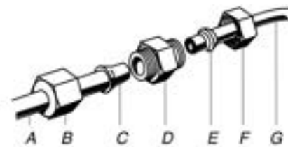
A. Tuyau d'eau du réfrigérateur B. Écrou (fourni) C. Ampoule D. Raccord (à acheter) E. Virole (à acheter) F. Écrou (à acheter) G. Canalisation d'eau du domicile
