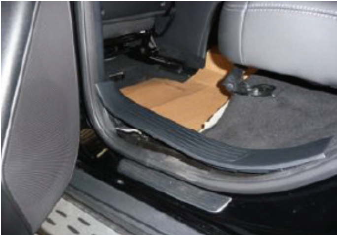
Remove door sill
