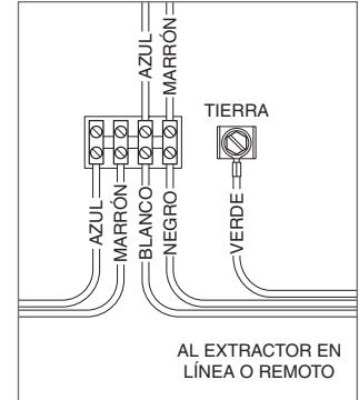
Cableado del extractor en línea/remoto
