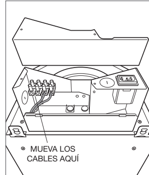
Ubicación del cableado
